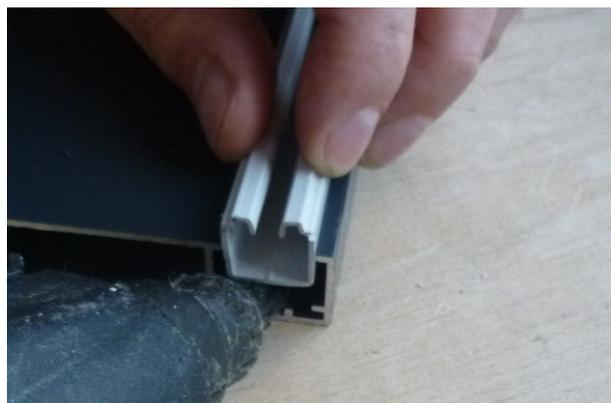
14. Immobilisez les extrémités du profilé de guidage aux extrémités du rail de guidage à l'aide d'un adhésif de montage au silicone ou d'un adhésif à chaud au silicone.
